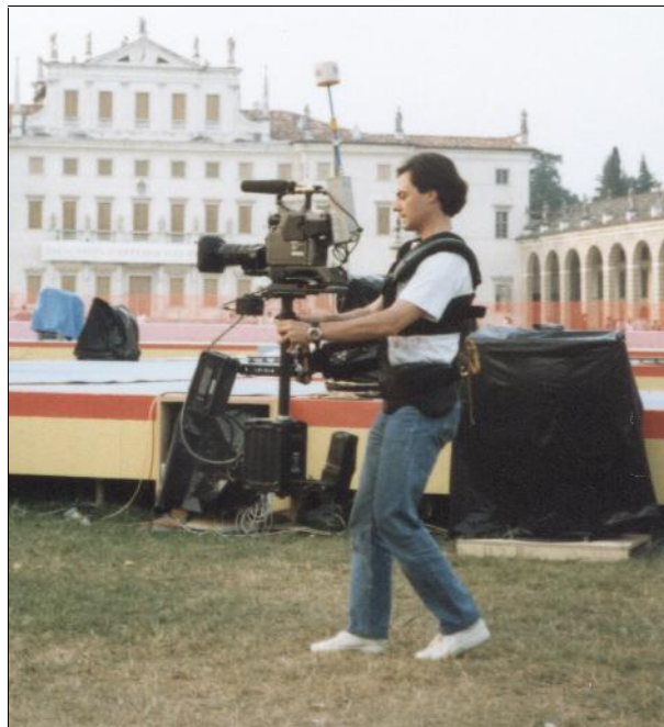
Operatore steadycam. Il baricentro è spostato in avanti, per cui l'operatore deve assumere una posizione innaturale, non eretta ma inclinata all'indietro.
