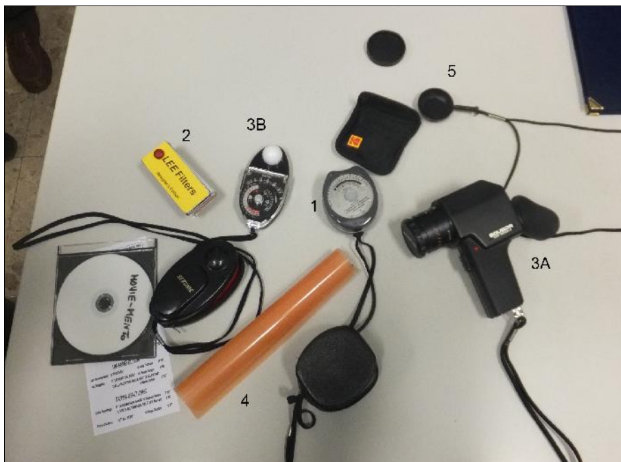
Gli attrezzi del Direttore della Fotografia: 1 il termocolorimetro, 2 le mazzette delle gelatine colorate, 3A esposimetro per luce riflessa, 3B esposimetro per luce incidente, 4 foglio di filtro per corpo illuminante, 5 lente di contrasto.
